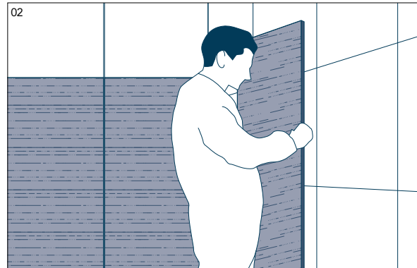
Anbringen eines Schuttkartons auf der verlegten Wand.
