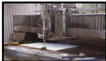
**Abb.17** - SLIMTECH, in allen Ausführungen, kann auch mit Wasserstrahlmaschinen zugeschnitten werden. Wir empfehlen den Einsatz mit einer Arbeitsgeschwindigkeit zwischen 2 und 3 m/min.
