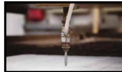
**Abb.19** - SLIMTECH, in allen Ausführungen, kann auch mit Wasserstrahlmaschinen gebohrt werden.
