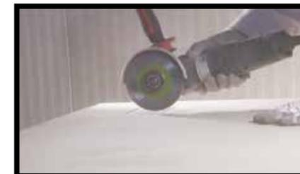
**Abb.13** - Die gleichen Ergebnisse lassen sich auch mit auf Winkelschleifern montierten Schmirgelscheiben erzielen.
