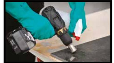
**Abb.9/10** - Alternativ können auf Schleifmaschinen, Elektrobörern oder Akkuschaubern montierte Spiralfräser (oder Lochsägen) verwendet werden.
