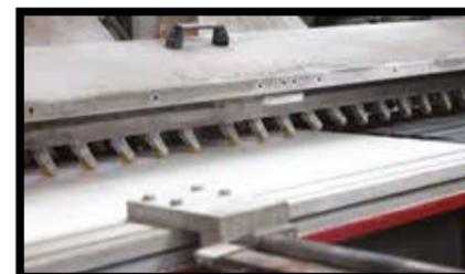
**Abb.21** - Für die Anfertigung eines 45°-Schnitts können um 45° geneigte Diamantscheiben verwendet werden. Auf diese Weise kann eine Kante mit zwei Platten von SLIMTECH, in allen seinen Ausführungen, gefertigt werden. Danach ist die neue Kante abzurunden. Mit unterschiedlichen Schleifscheiben können zahlreiche Kantenverarbeitungen erzielt werden. Die Arbeitsgeschwindigkeit ist vorher zu testen.
