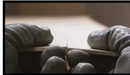
**Abb.3** - Nach dem Einritzen können die beiden Teile durch einfaches Biegen getrennt werden.
