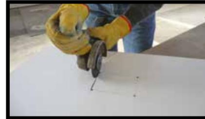
**Abb.11** - Für die Ausführung von Innen- und „L“-förmigen Schnitten wird empfohlen, die Spitzen der Öffnung mit Bohrspitzen mit 5 mm Mindestradius abzurunden, um das Bruchrisiko zu reduzieren. Danach den Schnitt mit Diamantscheiben vorsichtig fortsetzen, um den Vorschub zu unterbrechen, sobald die zuvor gefertigte Bohrung erreicht wird. Beim Fertigen der Bohrung und des Schnittes mit Diamantscheiben sind die obigen Angaben zu befolgen.
