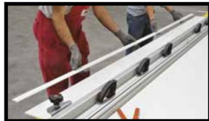
**Abb.5** - Ein praktisches Schneidinstrument ist der Fliesenschneider (Typ Keracut von Sigma oder Free-cut von Raimondi). Bei SLIMTECH 3PLUS und SLIMTECH 5PLUS muss der Schnitt nach dem erfolgten Einkerbungen des Keramikteils und nach dem Trennen der Platte durch Einschneiden der Glasfaser mit einem normalen Cuttermesser vollendet werden (**Abb.4**).
