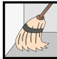
**Abb.26** - Die Oberfläche des Untergrundes muss sauber sein. Staub, Öle, Fett, Schmutz und Schutt sind zu entfernen, da sie das Haftvermögen des Klebers beeinträchtigen können.
