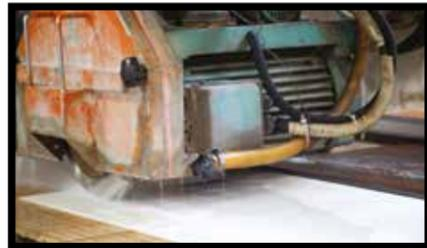
**Abb.15** - SLIMTECH, in allen Ausführungen, kann auch mit Diamantscheiben gebohrt werden. Die Scheiben müssen für Feinsteinzeug geeignet sein und einen guten Zustand aufweisen. Es wird empfohlen mit hohen Drehgeschwindigkeiten (>2000 Umdr./Min) und einer Vorschubgeschwindigkeit zwischen 0,5 und 1 m/min. vorzugehen. Je nach Scheibentyp und Schnittlänge kann eine Wasserkühlung der Trennscheibe notwendig sein.
