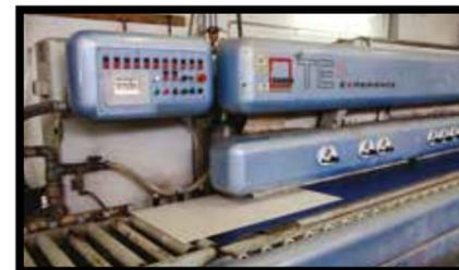
**Abb.20** - Zur Gestaltung und Polierung der Randkante müssen die Kanten zuerst mit Diamantschleifscheiben in die gewünschte Größe und Form gebracht und dann mit einer Polierscheibe poliert werden. Mit unterschiedlichen Schleifscheiben können zahlreiche Kantenverarbeitungen erzielt werden. Die Arbeitsgeschwindigkeit ist vorher zu testen.
