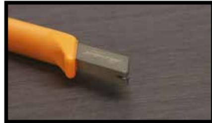
**Abb.1** - Durch Einkerbungen der verschiedenen Typen von SLIMTECH mit Glasschneidern vom Typ Silberschnitt 2000, dem Spezialglasschneider **Bohle Italia** oder dem manuellen Fliesenschneider von **Würth**, können ausgezeichnete Schnitte und Formen erzeugt werden. Bei der Fertigung von Einkerbungen ist es auf jeden Fall wichtig, den Glasschneider während des gesamten Arbeitsvorgangs nicht von der Einkerbungsachse abzuheben.
