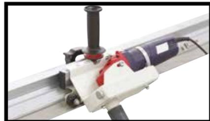
**Abb.6** - Mit dem Regal des Fliesenschneiders können manuelle Winkelschleifer verwendet werden, die in einem entsprechenden Rahmen eingesetzt werden und auf der Schneidföhrung entlang gleiten. Auf diese Weise können sowohl 90°-Schnitte als auch 45°-Schnitte ausgeführt werden, um Abschrägungen und Jolly-Schnitte zu erzielen.
